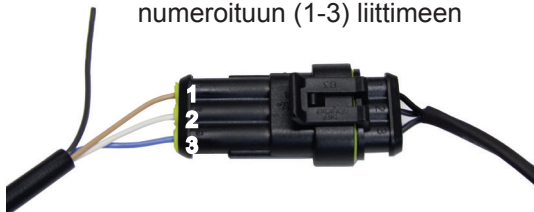
Kuva 3 Anturikaapelin kytkentä 3-napaiseen numeroituun (1-3) liittimeen
